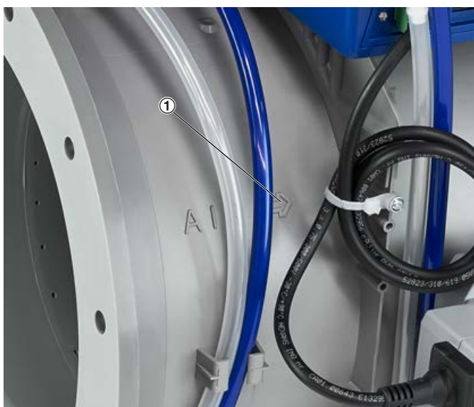
Rys. 9: Strzałka wskazująca kierunek przepływu powietrza na TVLK
