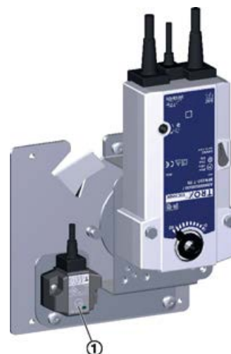
Rys. 209: Sprawdzenie poprawności działania (FK2-EU z siłownikiem BFN pokazana w położeniu OTWARTA)
