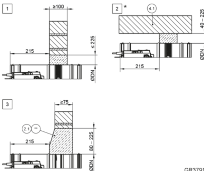
Rys. 39: Montaż z wykorzystaniem zaprawy w ścianach sztywnych
