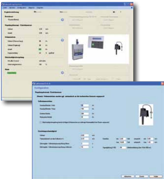
Okno dialogowe systemu regulacji dygestorium z czujnikiem prędkości przepływu powietrza
