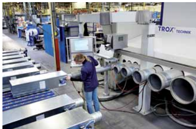
Produkcja, sprawdzenie i kalibracja regulatorów przepływu w fabryce
